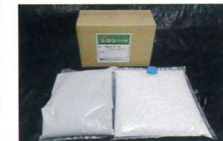
アンダーフィラー (グレー) 荷姿8kg/ケース 粉体4kg 液体4kg 施工面積約18㎡ 細目砂骨ローラーで塗布
