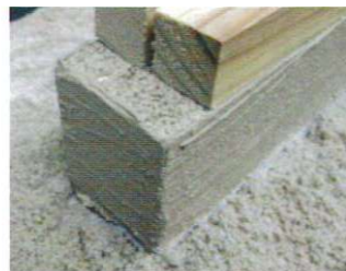
CTバリアー塗布の試験体 (蟻道の形成なし)
