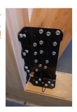
●内付けの場合、それぞれビス頭が6mm程度出ています。その分、外付けに比べ延長木材の長さを調整し、取付してください。
